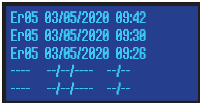
Anzeige der Ereignisse im Format Fehlercode - Datum - Uhrzeit.
