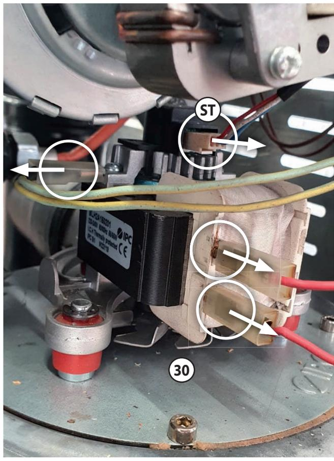
**i** La connexion (**ST**) située en haut à droite sur l'image résiste à être déconnectée : il faut exercer une légère pression sur le mécanisme de verrouillage situé en-dessous pour déverrouiller et pouvoir retirer la fiche.
