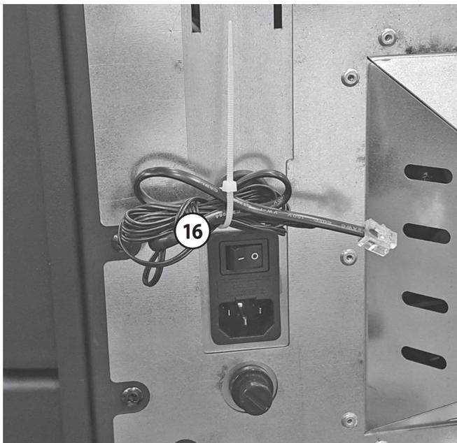
**i** La **sonde de température ambiante (16)** est placée à l'arrière de l'appareil, près du sol, qui est normalement l'endroit le plus froid de l'appareil.
