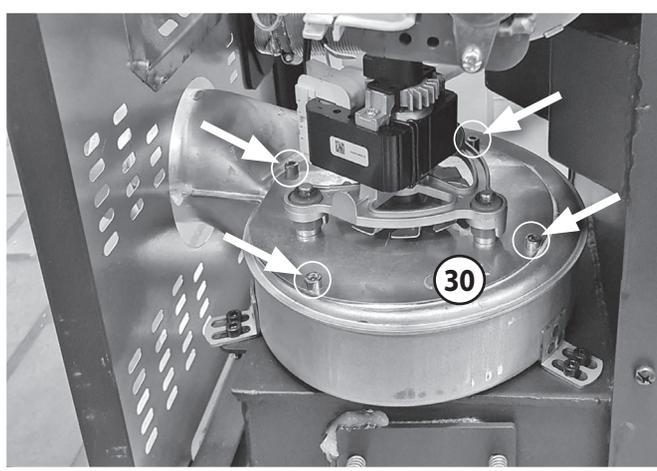
En sortant le **ventilateur d'extraction (30)**, veillez à ne pas endommager le câble de connexion ni la roue à ailettes.
