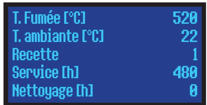
**i** La valeur de température des fumées affichée sur l'écran correspond à la température située directement au-dessus de la chambre de combustion. Des valeurs supérieures à 500°C sont donc parfaitement normales.
