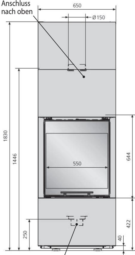
Anschluss externe Verbrennungsluftversorgung unten/hinten Ø 100 mm
