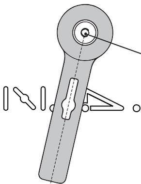
**Sekundärluft maximal geöffnet und zusätzliche Primärluft**
