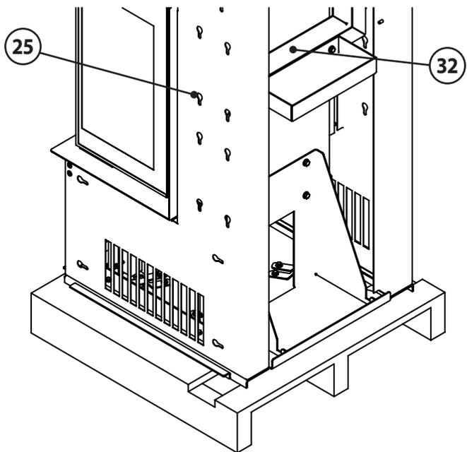
**i** Die **Transporthilfe (32)** befindet sich bei Auslieferung an der Rückseite des **Heizeinsatzes (25)**.
