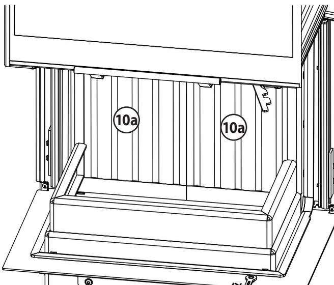
In der Rückwand des **Heizeinsatzes (25)** finden sich korrespondierende **Sekundärluftbohrungen** zu den **Sekundärluftbohrungen** in beiden **Rückwandsteinen (10a)**.
