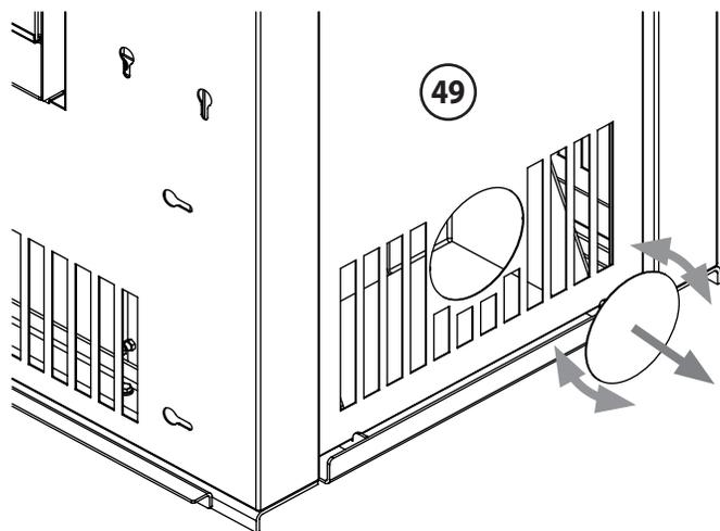
Jetzt kann der Anschluss für externe Verbrennungsluftversorgung von unten oder von hinten zum **Verbrennungsluft-Stutzen (31)** am **Heizeinsatz (25)** hergestellt werden.
