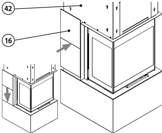
Anschließend wird ein zweites **Verkleidungselement hinten (16)** an der rechten Geräteseite montiert.
