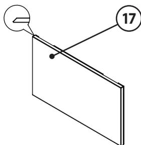
Der Karton mit dem Aufkleber „9217 17“ enthält die Bauteile der keramischen Feuerraumauskleidung.
