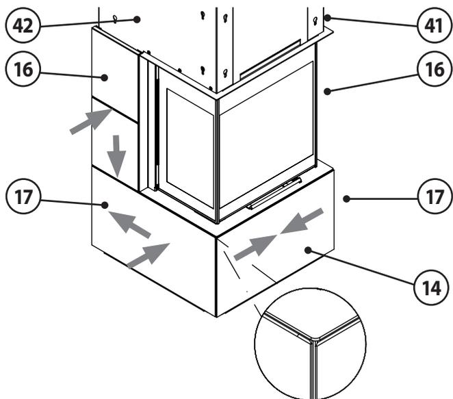
Bei der Ausführung **conStone** wird der obere Bereich der Verkleidung, im Gegensatz zur Ausführung **Sintered Stone** mit einer Lage aus **3 Verkleidungselementen**, aus 2 Lagen mit zusammen **6 Verkleidungselementen** gebildet.
