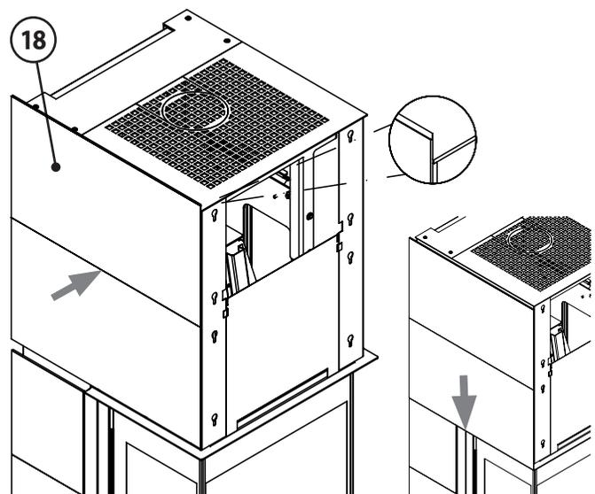
Anschließend wird ein zweites **Verkleidungselement seitlich oben (18)** an der rechten Geräteseite montiert.
