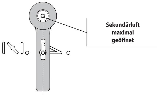
Sekundärluft maximal geöffnet
