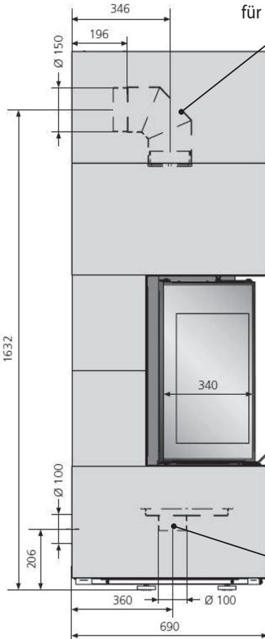
Anschluss externe Verbrennungsluftversorgung unten/hinten Ø 100 mm
